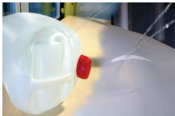
AIDIMA © - Ensayo de presión interna (hidráulica) donde se aprecia la rotura del envase.
