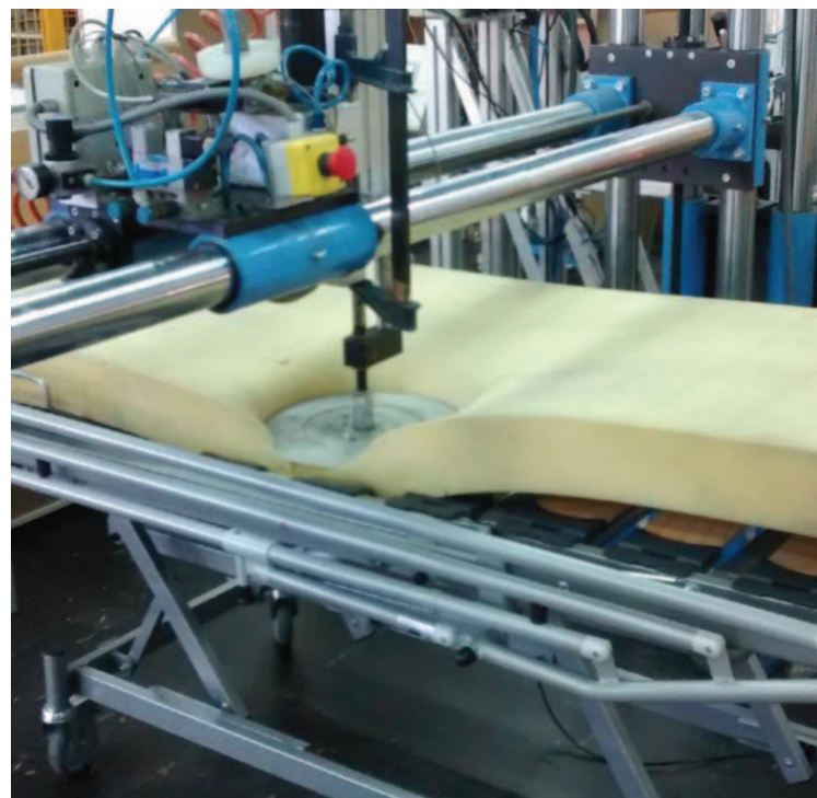
© AIDIMA - Ensayo de fatiga dinámica donde se simulan esfuerzos debidas al sentado, levantamiento, manejo del paciente o procesos similares.
