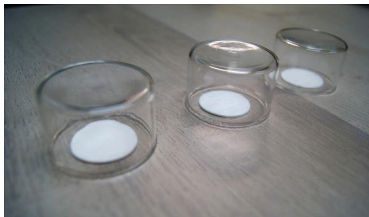
© AIDIMA - Ensayo de resistencia de la superficie a los líquidos fríos.
