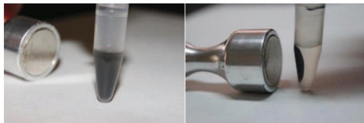
© AIDIMA - Separación magnética de nanocompuestos para su reutilización en la depuración de aguas residuales.
