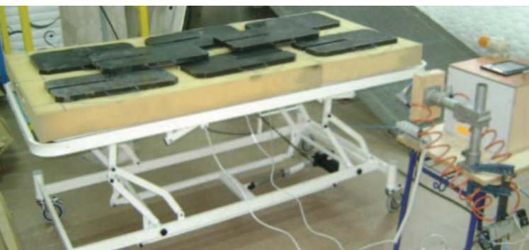
© AIDIMA - Ensayo dinámico del mecanismo de ajuste de altura.
