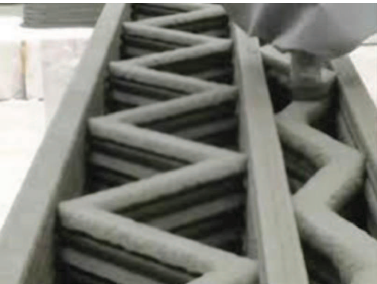
Fabricación de elementos de construcción con tecnología aditiva.
