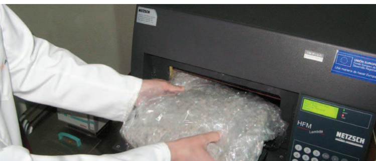
© AIDIMA - Análisis de la conductividad térmica en una muestra experimental de aislante térmico de celulosa reciclada.
