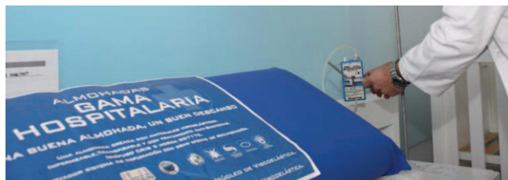
AIDIMA© - Dispositivo de medición de la calidad del aire, en este caso para espacios hospitalarios.
