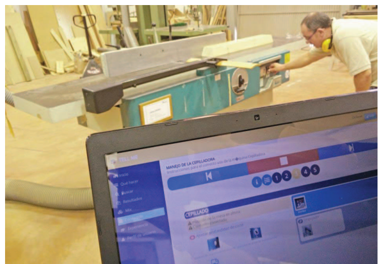
© AIDIMA - Manejo de la Cepilladora siguiendo las instrucciones provistas por el sistema TELLME.
