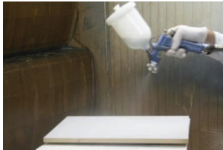
© AIDIMA - Proceso de pintado de tablero derivado de la madera mediante el uso de pinturas en base agua en cumplimiento de la directiva 2004/42/ce.
